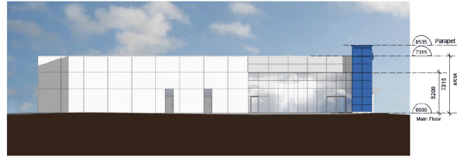
7 North Elevation - Building A scale: N.T.S.
